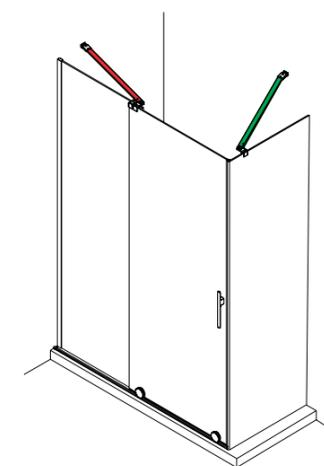
Mampara angular (pag 40) compuesto por un frontal, con tensor frontal y con lateral fijo.
