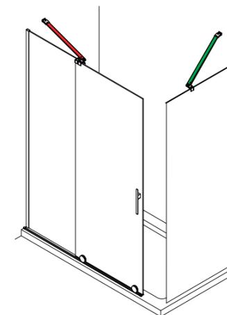
Mampara angular (pag 42) compuesto por 2 frontal, con tensor angular y kit magnético angular.
