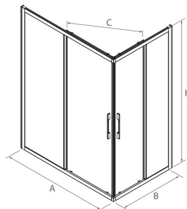
Anchura mínima: 600 mm, Anchura máxima: 1400 mm / Altura mínima: 1000 mm, Altura máxima: 2000 mm
