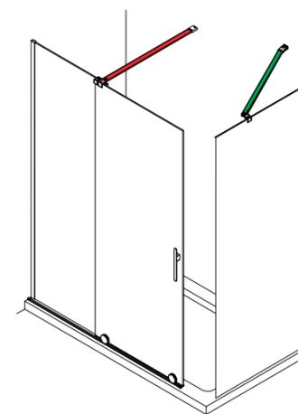
Mampara angular (pag 40) compuesto por un frontal, con tensor angular y con lateral fijo.
