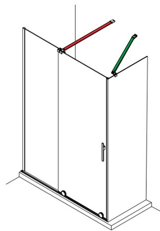
Mampara angular (pag 40) compuesto por un frontal, con tensor angular, con lateral fijo y kit magnético angular.
