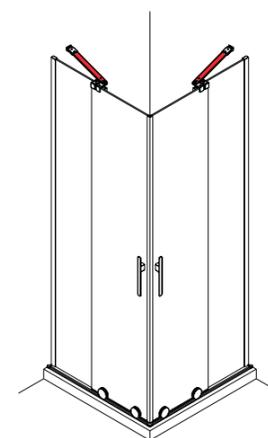
Conector para dos tensores Solo válido para mamparas angulares
